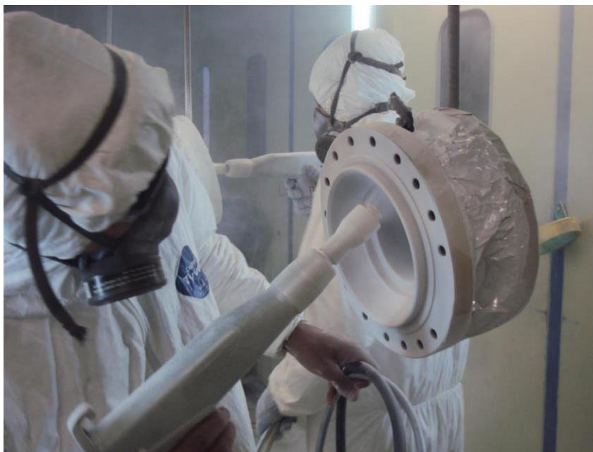
Figura 2 - Aplicação do revestimento pelo processo eletrostático.
