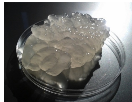
Figura 1: MCF pulpa corteza blanqueada oxidada con 5mmol de NaClO. 4 pasadas 600 bar
