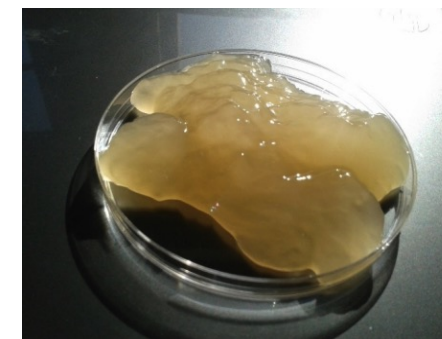
Figura 2: MCF pulpa corteza no blanqueada oxidada con 5mmol de NaClO. 4 pasadas 600 bar
