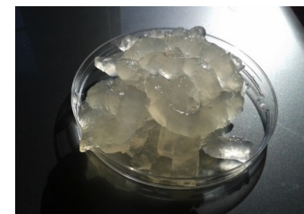
Figura MCF pulpa madera no blanqueada oxidada con 5mmol de NaClO. 4 pasadas 600 bar
