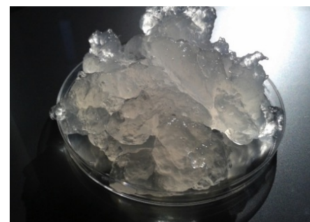
Figura 1: MCF pulpa corteza blanqueada oxidada con 5mmol de NaClO. 4 pasadas 600 bar
