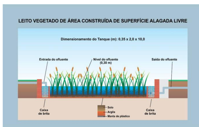
Figura 1: Leito vegetado de área construída de superfície alagada livre. Fonte: o autor
