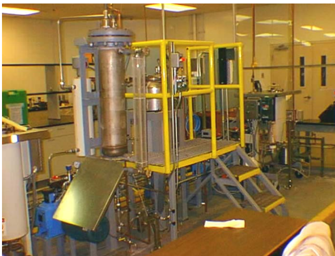
Figura 1. Sistema para simulação laboratorial de cozimentos modificados disponível no IPST.
