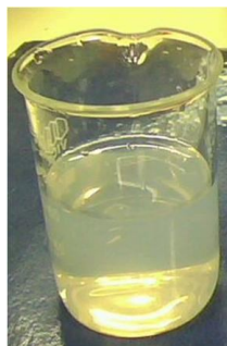
Figura 5 – Suspensão de nanocristais de celulose após diálise.
