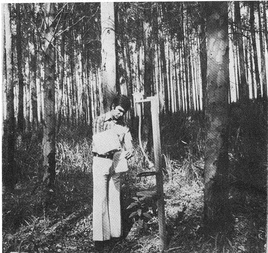
Coleta de amostra de água da precipitação interna em povoamento de eucaliptos.
