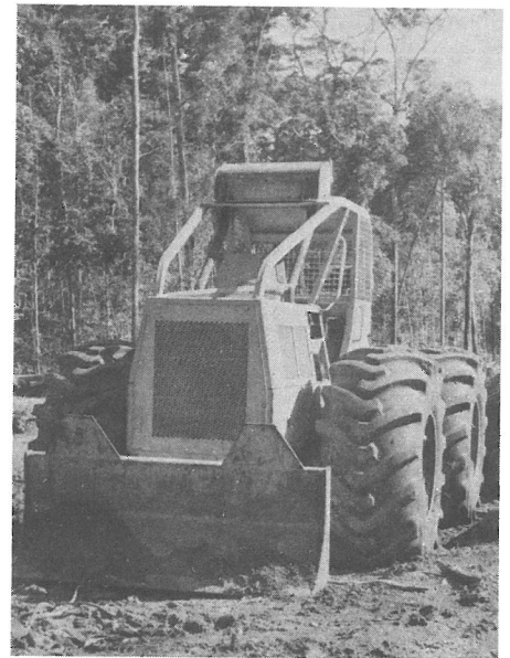
Trator para arraste da madeira; rendimento médio de 20 m 3 de madeira depositada nos pátios intermediários por hora de efetivo trabalho.
