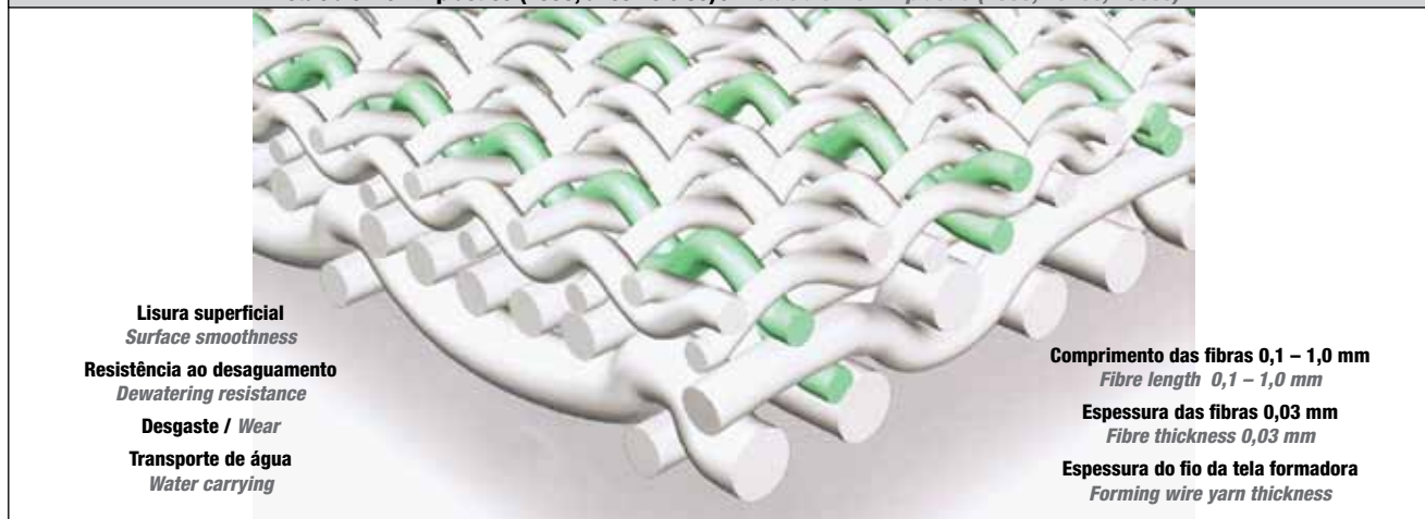
Figura 8. Principais pontos de interesse e condições limite no desenvolvimento da tela formadora Figure 8. Main points of interest and boundary conditions in forming wire development
