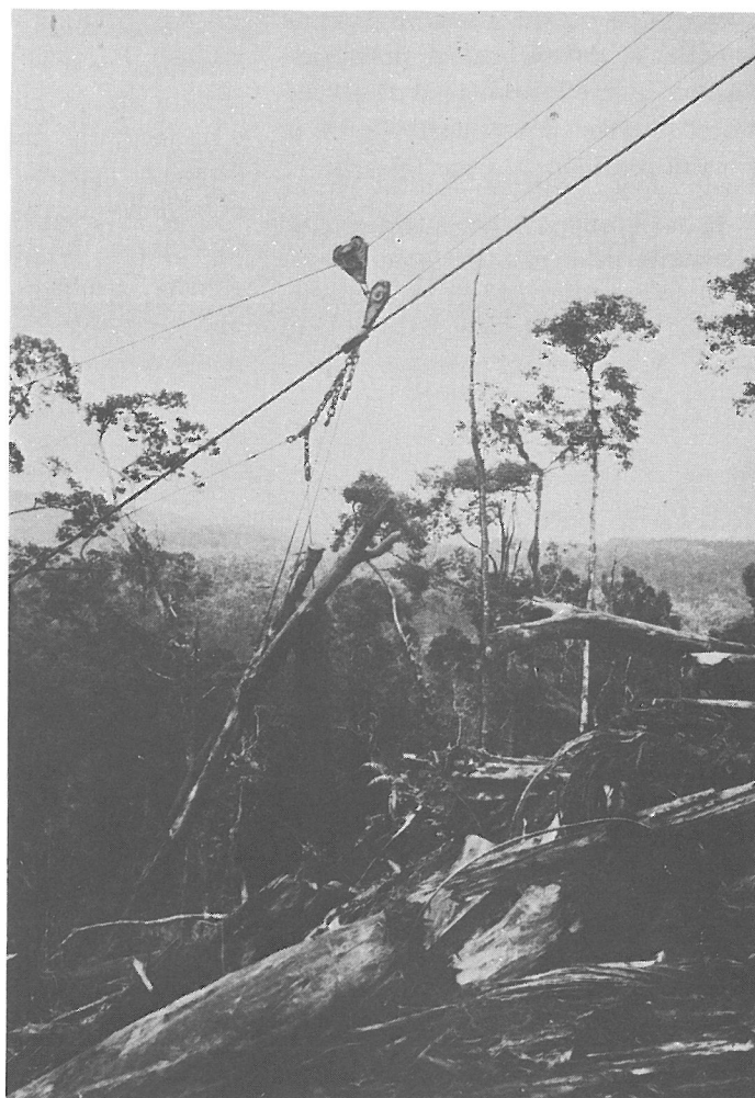
● Um moderno sistema de cabos transporta as toras até o local de carregamento.
