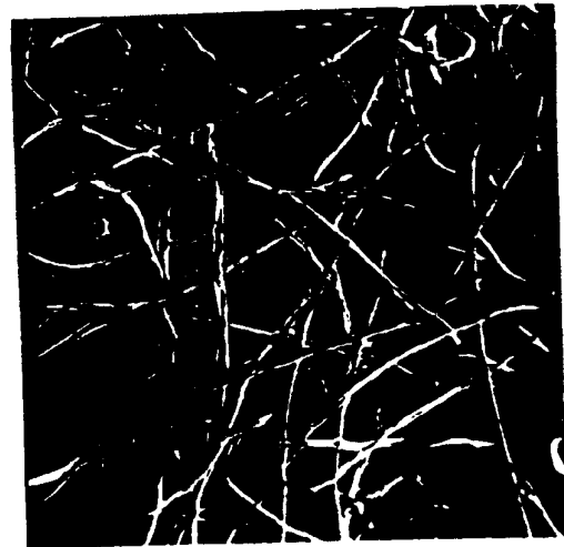
Fotografía 7. Pulpa seca hasta ts = 80^{\circ}C refinada hasta 9000 rev. Aumento: 36 X
