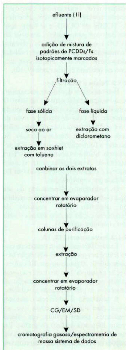
Fig. 2: Esquema geral de análise de efluentes de fábrica de celulose e papel (5).
