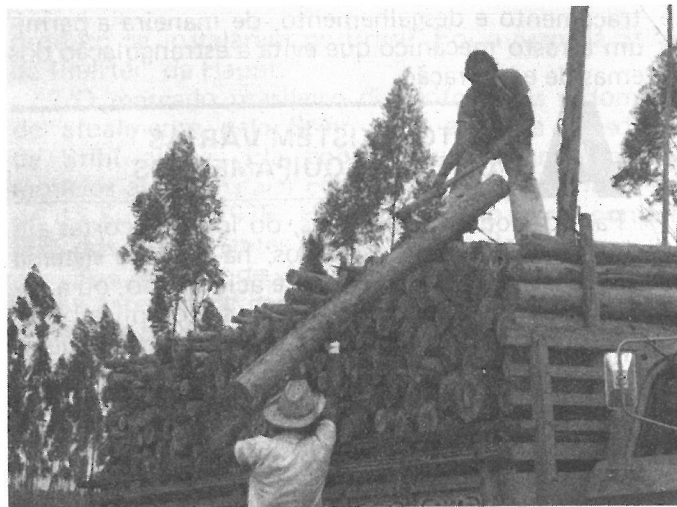
Carga manual. Um tronco de cada vez. O caminhão é comum e segue diretamente para a fábrica. Ainda é utilizado hoje em dia.
