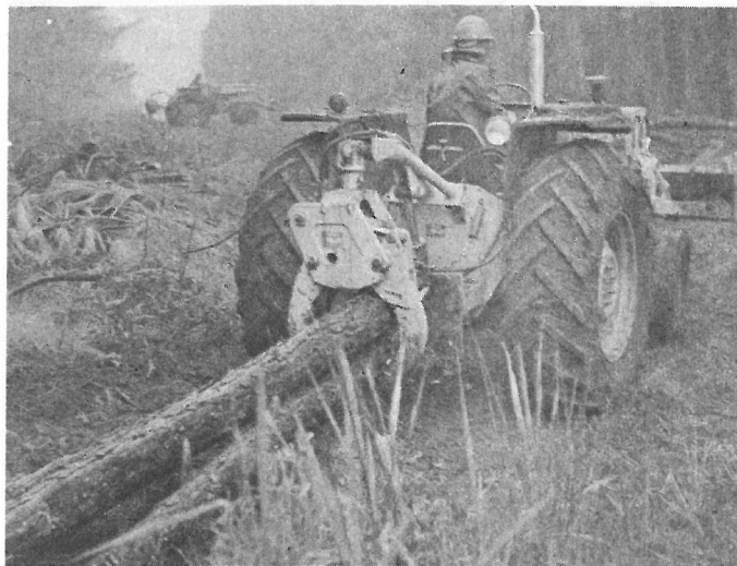
Miniskidder , para o arrasto de toras. É um equipamento Munckjons adaptado a um trator Massey Ferguson.
