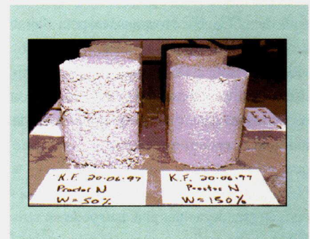
Figura 2 - Resíduos do destintamento compactados nos limites seco/molhado do ponto Proctor ótimo
