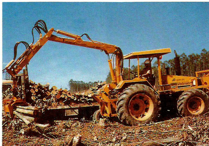
CF- 2550, da Valmet. Projetado para aplicações onde não exista grande volume de madeira a ser manuseado.
