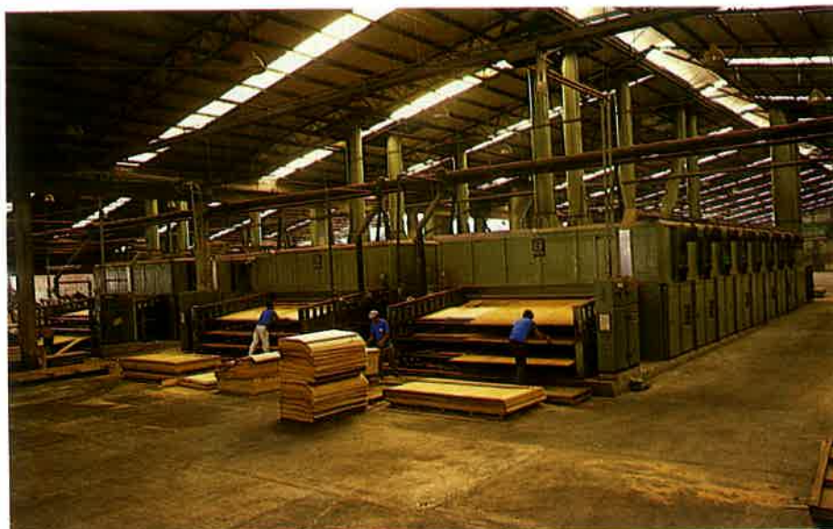
Lixadeira de compensado, acabamento do produto.
