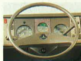
Painel com iluminação translúcida e alavanca de seta com múltiplas funções.
