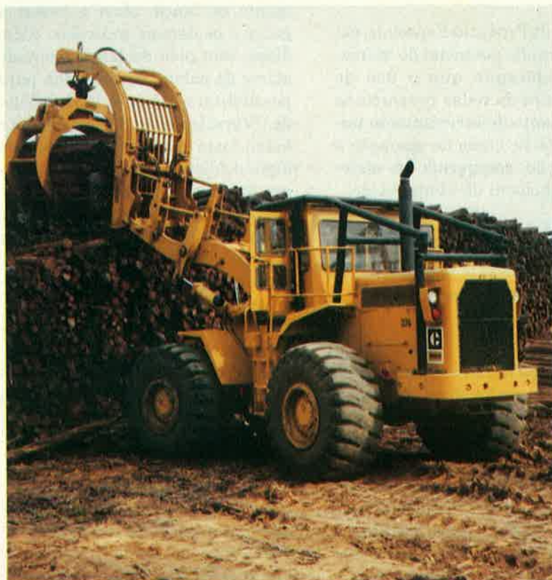
Carregadeira de rodas 966, com garra tipo pinha (à esquerda), e a 930 SR (abaixo), da Caterpillar.
