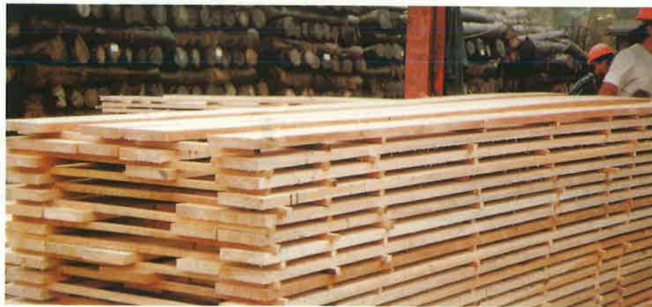
Num primeiro plano, madeira serrada de E. globulus e, atrás, toras da mesma espécie armazenadas sob aspersão de água, na Forestal Xolcura.
