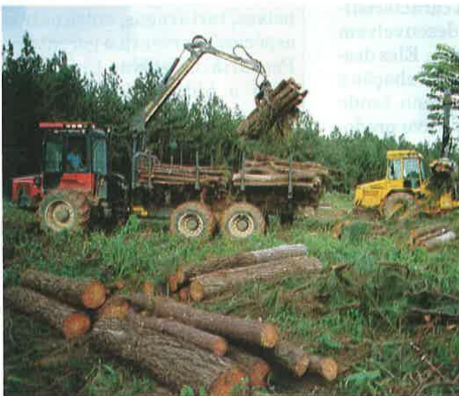
Forwarder utilizados no baldeio, para o carregamento de toras.
