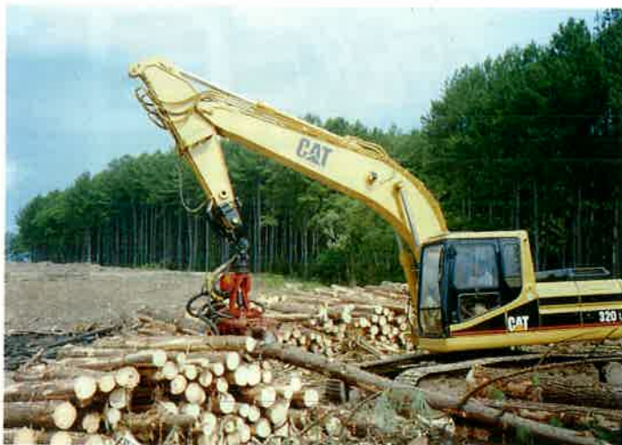
O sistema próprio da Pisa conta com um harvester para o processamento.
