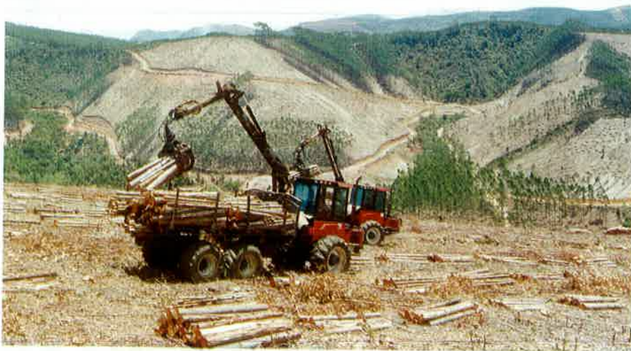
Forwarder Valmet 636 possui tração 6x6 e controles por joystick.
