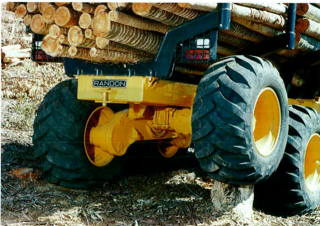
Forwarder RK 610/612 possui pneus específicos para o trabalho florestal.
