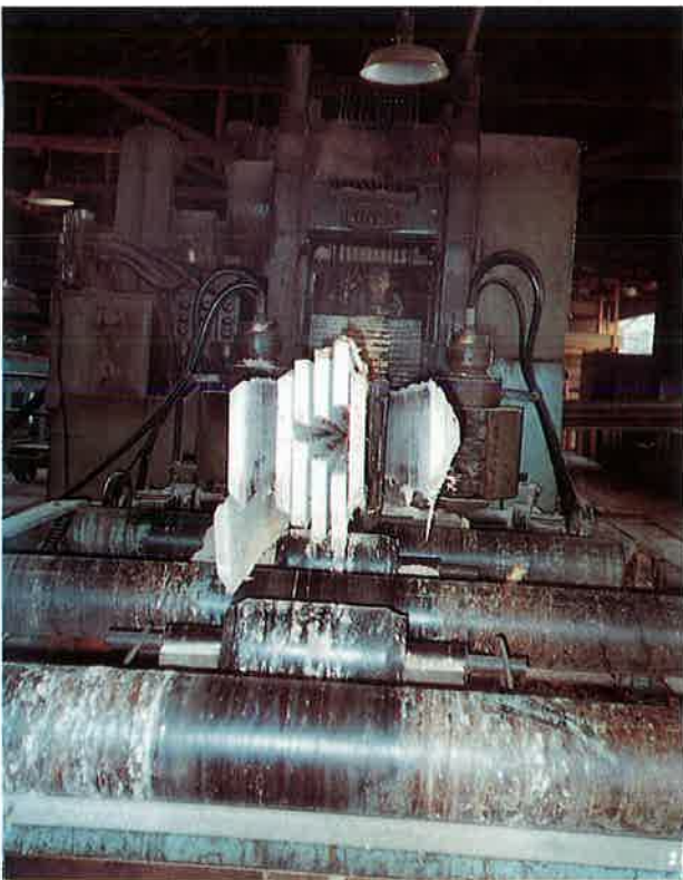
Foto 1 - Empenamentos e rachaduras em tábuas de eucalipto ocasionados pela liberação das tensões de crescimento.
