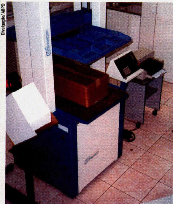
O teste de compressão de caixa é o mais completo do Laboratório da ABPO
