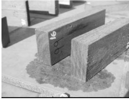
Figura11: La muestra impregnada bajo presión con aceite de lino expulsó aceite durante varios días en el proceso de secado a la intemperie.
