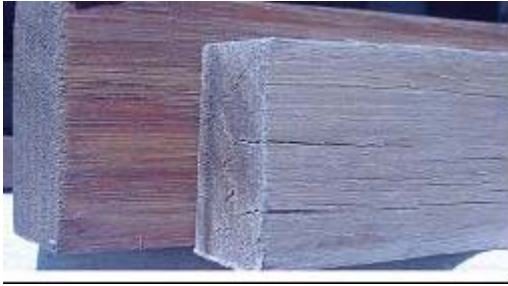
Figura13: Maderas sometidas a la acción de tres meses de intemperie. Muestra impregnada con aceite de soja + aditivo (no agrietada) y muestra de madera no impregnada (agrietada)
