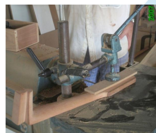
Fig. 3: Usinagem do braço
