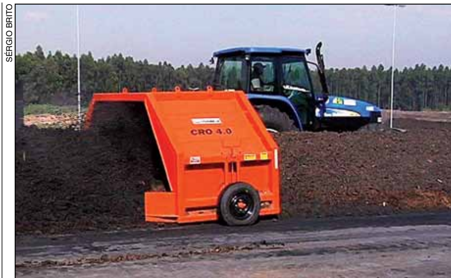
Equipamento responsável pelo revolvimento de leiras (montes)
