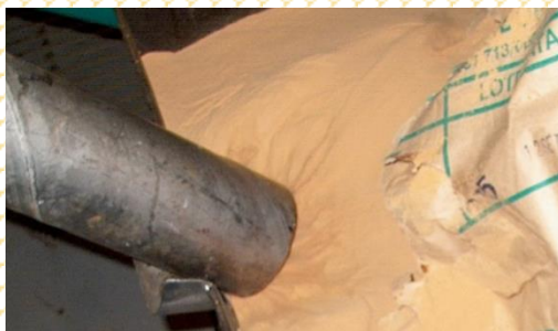
Lignossulfonato (pó) obtido de lignina de Pinus extraída por polpação sulfito ácido da madeira
