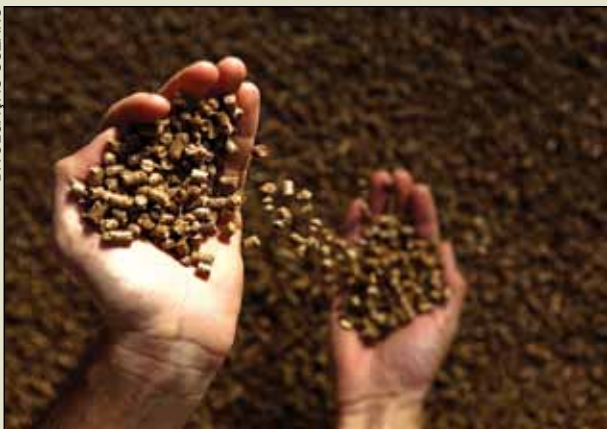
Madeira picada, desidratada e prensada dá origem aos pellets
