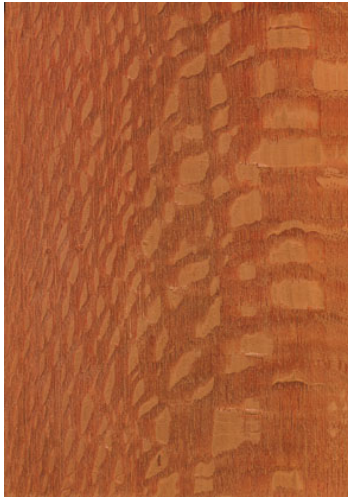
Figura 7- Desenho em peça radial, devido ao raio muito desenvolvido. Madeira: louro-faia
