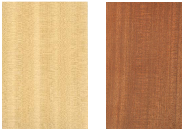
Figura 6 - Desenho em peça radial, devido à grã entrecruzada. Madeiras: figueira (a esquerda) andiroba (a direita).
