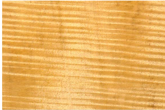
Figura 5 - Desenho "frisado" em peça radial, devido à grã ondulada. Madeira: inharé.
