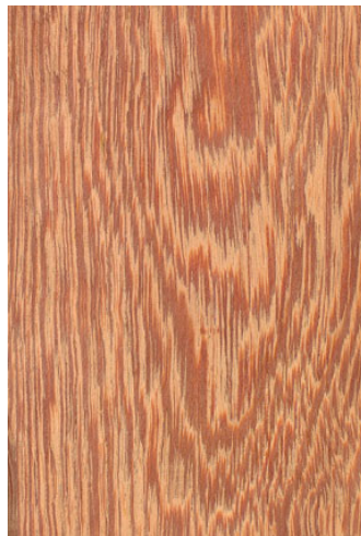
Figura 8- Aspecto fibroso em peça tangencial, devido ao contraste entre fibra e parênquima. Madeira: angelim-pedra.
